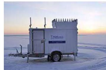
Système de mesure de vent SODAR
